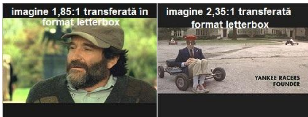
Fig.8 Exemplificare imagine wide 1,85:1 adaptată la format 4:3 (stânga) și imagine wide 2,35:1 adaptată la format 16:9 (dreapta)cu metoda letterbox[6]
