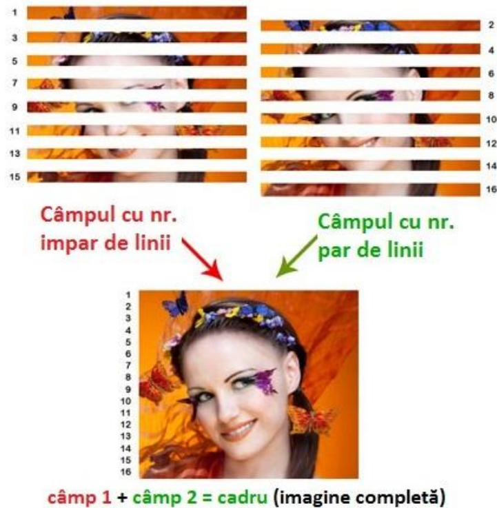
Fig.11 Modul de formare al imaginii întrețesute[7]
