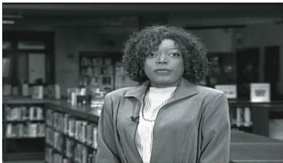
Fig.28 Imagine 4:3 afișată impropriu într-un cadru 16:9. Imaginea a fost "întinsă" pentru a umple întregul ecran (up-converting)[2]
